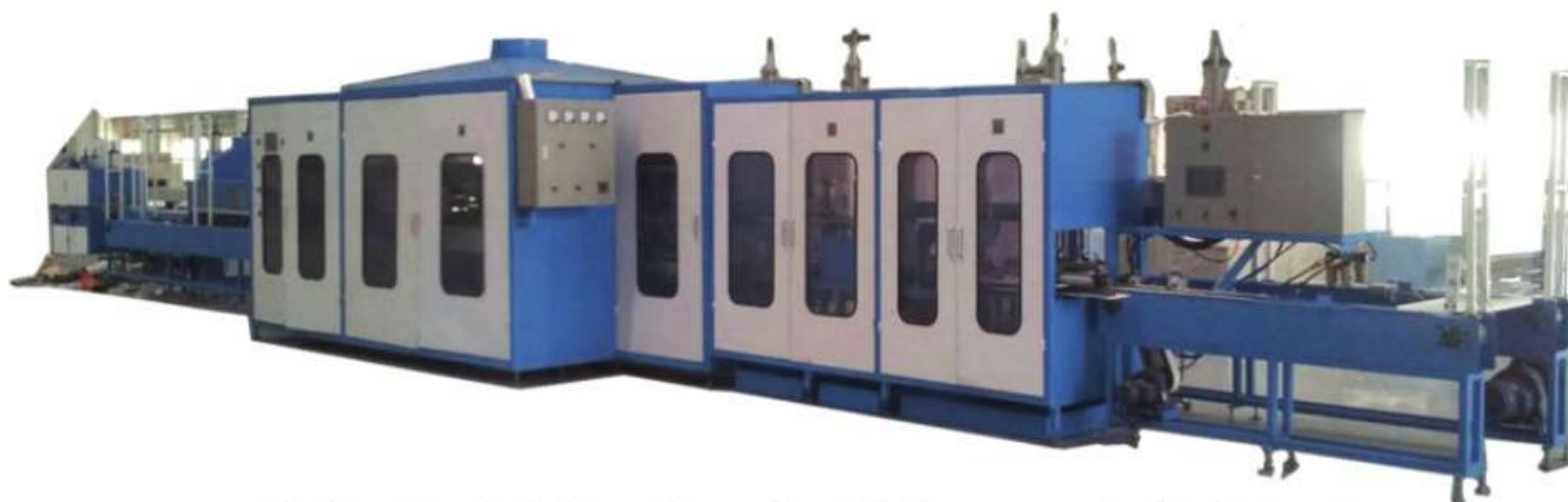
Linha cos totalmente autom á tica para baterias vrla
