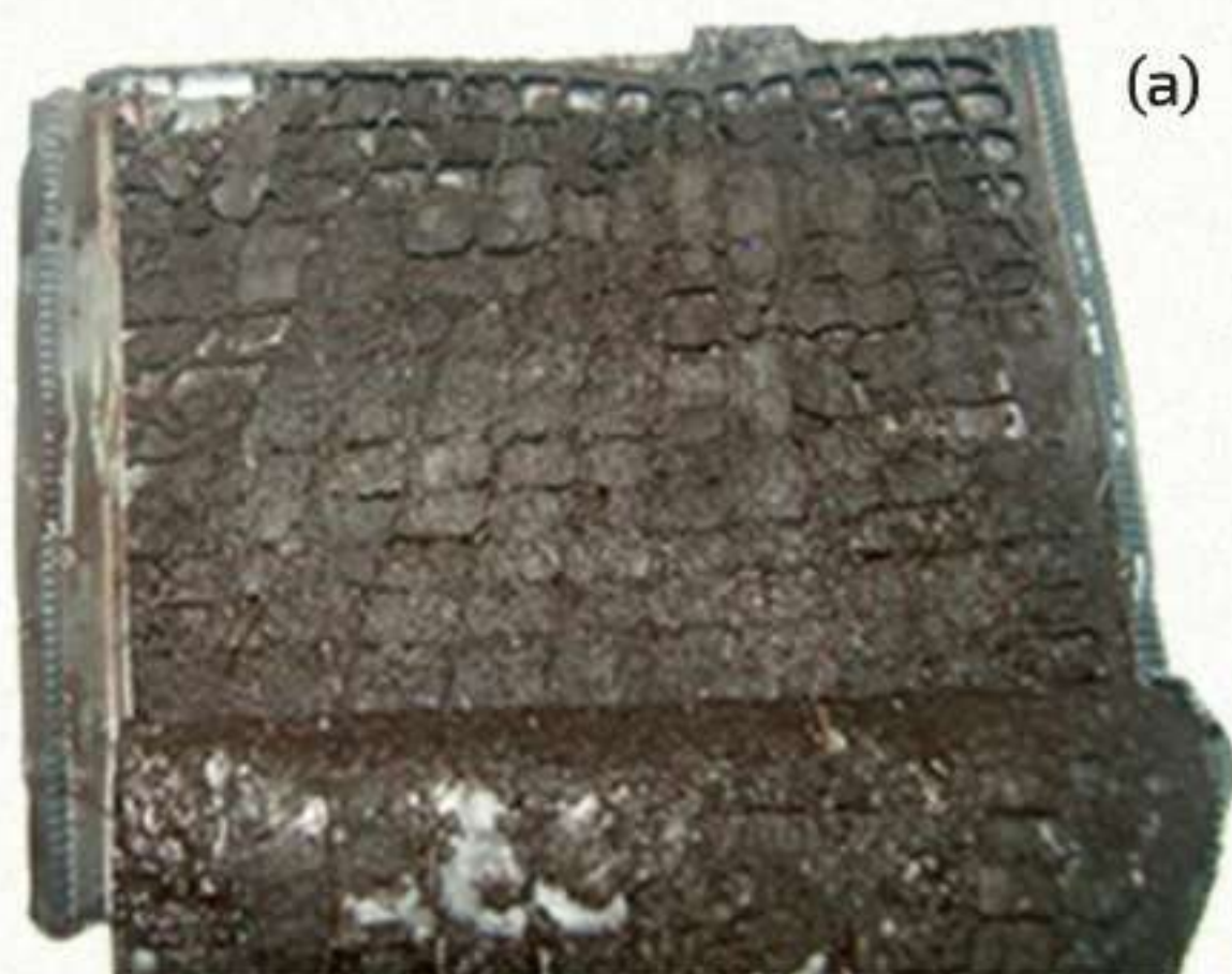
Figura 5 (a): placa positiva da bateria de referência após a remoção do separador: a queda de massa é claramente visível
