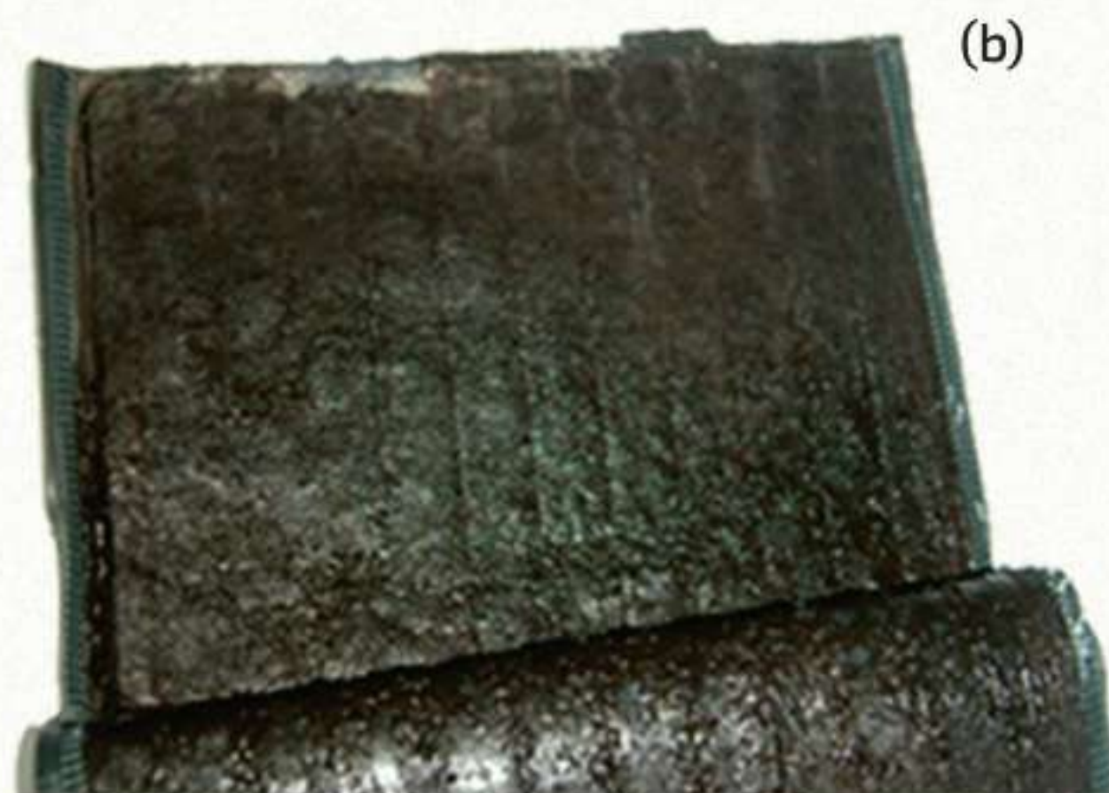
(b) placa positiva da bateria Dynagrid® NG após a remoção do separador: a massa ativa se mantém no lugar.
